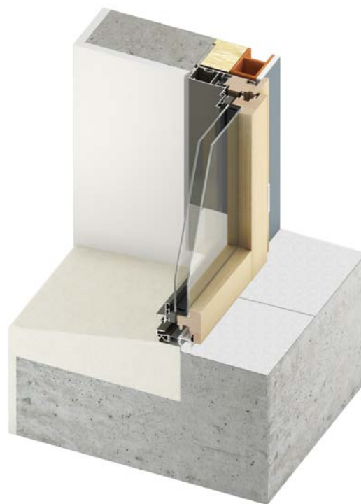
Dormant aile de 20 mm
