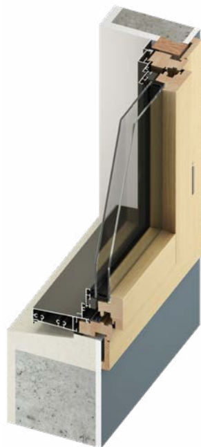
Dormant rainuré avec moulures d'habillage
