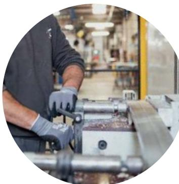
Chez DC, tous nos portails sont fabriqués à la main de A à Z. L'opération de cintrage est réalisée sur une cintreuse à rouleaux par un serrurier. Il règle la machine selon les tolérances préétablies au modèle et à sa largeur. C'est aussi ça le sur-mesure !
